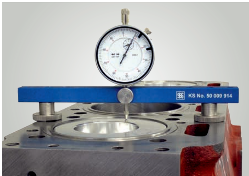
Przykład zastosowania: pomiar występu tłoka
